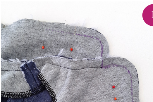
Bringe den Kragen in die richtige Position, so dass ein rechter Winkel entsteht.
