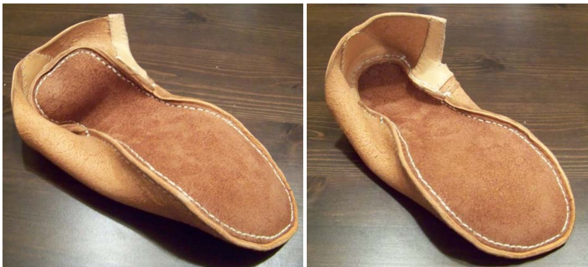
Abb. 24: Wenden des Schuhs im Fersenbereich
