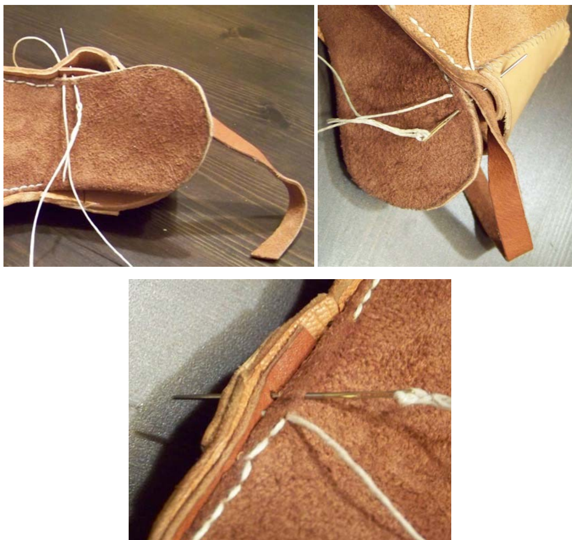
Abb. 22: Einbringen von Randstreifen in die Sohlennaht
