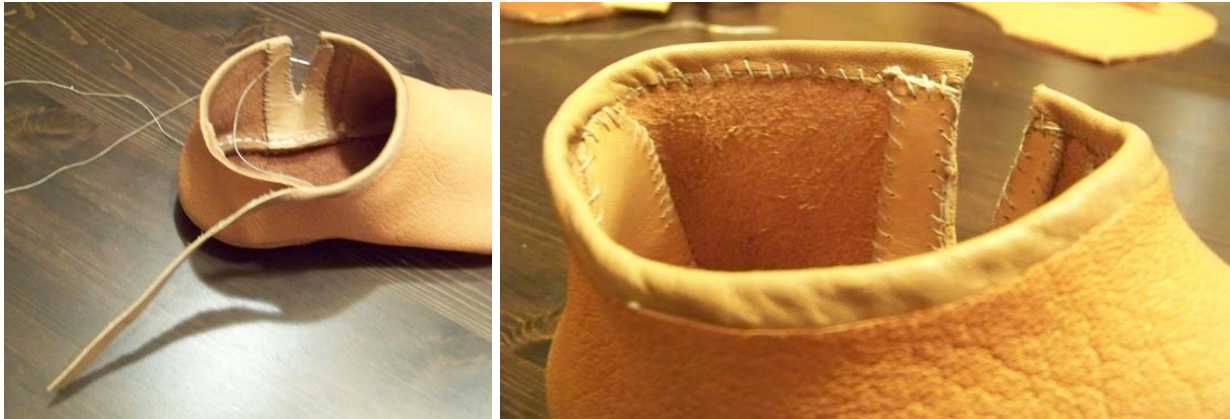
Abb. 28: Vervollständigung der Schaftrandeinfassung
