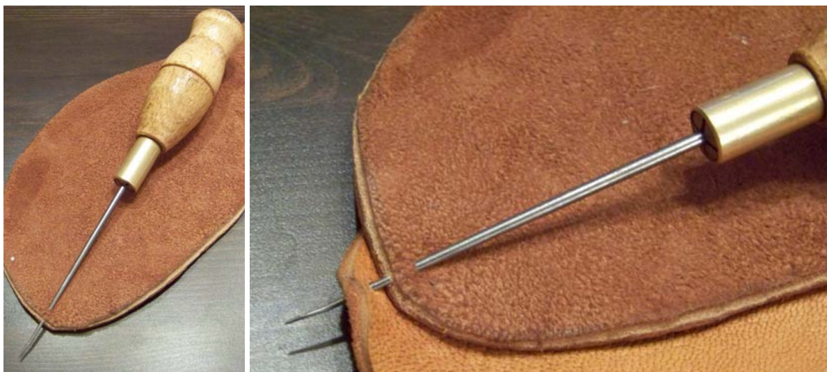
Abb. 16: Vorstechen der Sohlennaht
